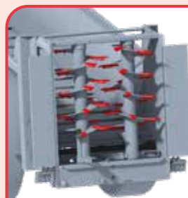
Zęby odwracalne, wymienne ze stali HARDOX 450
